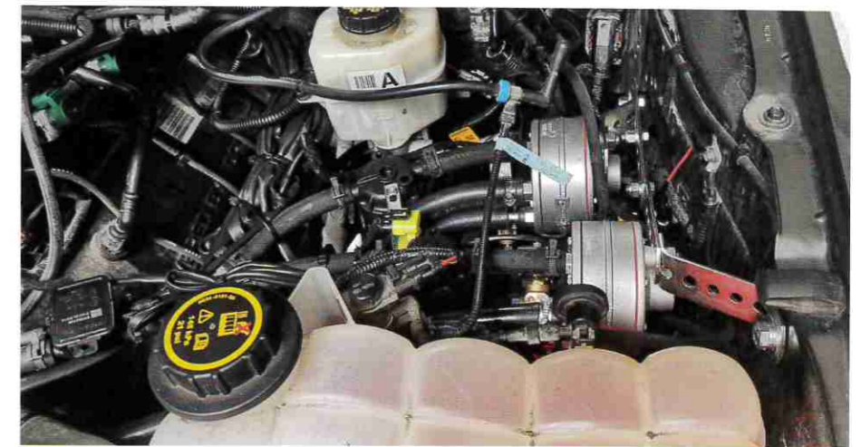
Auch mehr als sechs Liter Hubraum sind für Autogas kein Problem – wer solch sein Fahrzeug sein Eigen nennt, spart im Vergleich zu Benzin enorm. Aber zwei Verdampfer müssen sein.
