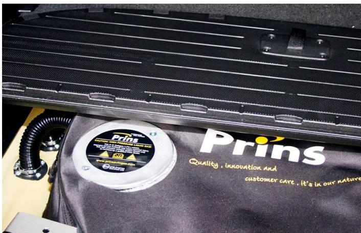
Der Gastank verschwindet unter dem Kofferraumboden, die Umhüllung soll die Geräusche der Pumpe im Gastank dämmen.
